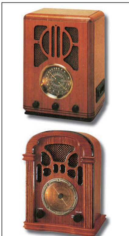
Figure 315 : Les premières radios (1930-1938) ne pouvaient recevoir que les émetteurs qui transmettaient en AM sur les ondes longues et moyennes. Toutes ces vieilles radios avaient besoin d'une antenne et d'une bonne prise de terre.
