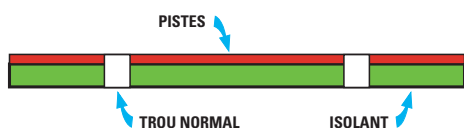
Figure 151 : Sont appelés « simple face » les circuits imprimés dont les pistes en cuivre figurent sur un même côté du support isolant.
