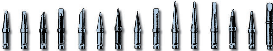
Figure 145 : Tous les fers à souder professionnels, c'est-à-dire les plus coûteux, sont dotés d'une série de pannes interchangeable de formes différentes. Les pannes fines sont utilisées pour souder les broches très rapprochées, les pannes moyennes pour des soudures normales et les plus larges, pour souder des surfaces importantes.
