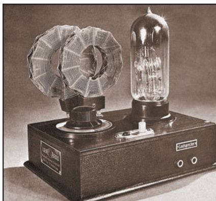
Figure 339 : Les premières valves thermo-ioniques (ou thermoionique, synonyme de thermoélectronique) utilisées pour la réalisation des récepteurs radio, apparurent vers 1910. Marconi, pour capter les signaux, utilisait des détecteurs rudimentaires, constitués d'un petit tube de verre contenant de la limaille de nickel (96 %) et d'argent (4 %). Sur la photo, un des premiers récepteurs radio à valve thermo-ionique.
