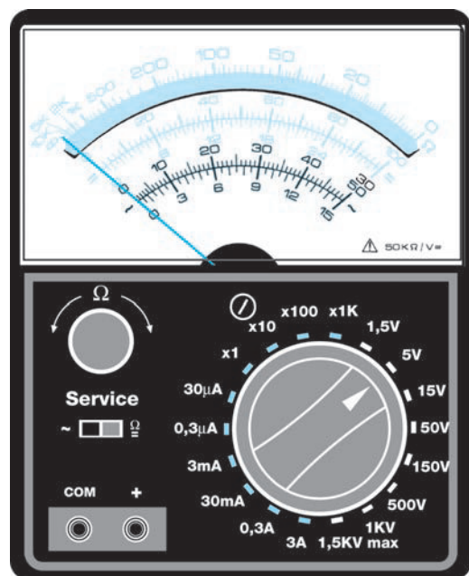
Figure 375 : Concernant la fonction voltmètre ou ampèremètre AC (courant alternatif), la valeur de la tension ou du courant alternatif sera lue sur l'échelle de couleur rouge. Avant d'effectuer une mesure AC, vous devrez penser à déplacer le levier de l'inverseur, de la position "CC- \Omega " à la position "AC". Sur certains multimètres, l'inverseur est remplacé par une douille "AC" sur laquelle doit être déplacé le cordon de mesure rouge.
