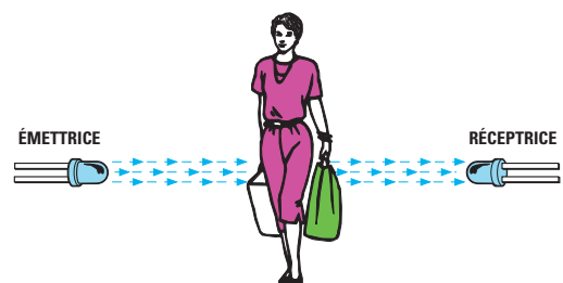
Figure 128 : Les photodiodes sont utilisées pour réaliser des ouvertures automatiques de portes, des antivols, des comptes-pièces.
