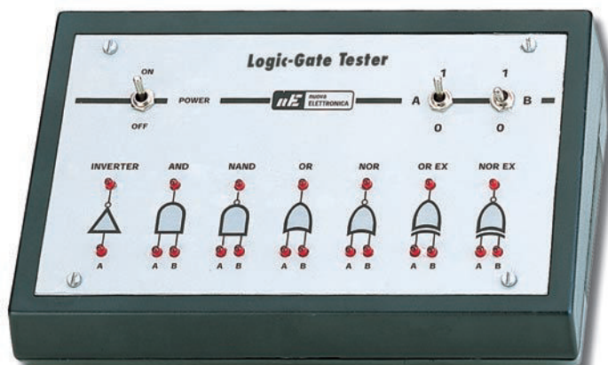
Figure 602 : Vous vous rendrez vite compte de l'utilité de cette table de vérité électronique, car elle vous permettra de savoir instantanément quel niveau logique sera présent sur la sortie d'une porte, simplement en modifiant les niveaux logiques sur les entrées.
