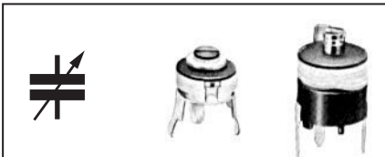
Figure 74 : Symbole graphique d'un condensateur ajustable. La flèche centrale indique que la capacité est variable.
