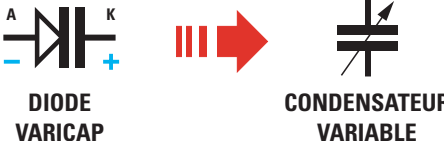
Figure 109 : Sur la gauche se trouve le symbole graphique d'une diode varicap. Ces diodes sont des petits condensateurs dont la capacité est variable.
