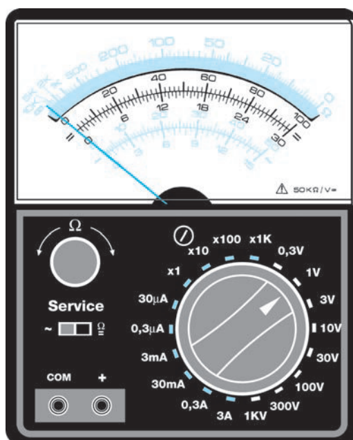
Figure 373 : Concernant la fonction voltmètre CC (courant continu), en tournant le bouton sur les échelles indiquées 0,3, 3, 30, 300 V, la valeur sera lue sur l'échelle graduée de 0 à 30, alors qu'en tournant le bouton sur les échelles indiquées 1, 10, 100 V, la valeur sera lue sur l'échelle graduée de 0 à 100.
