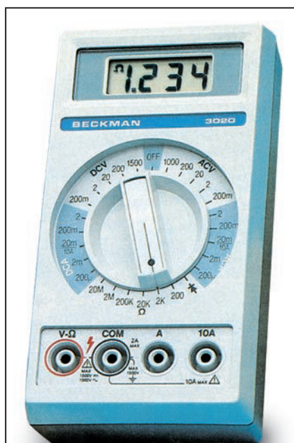
Figure 380 : Toutes les échelles des multimètres digitaux sont toujours des multiples de 2 car le chiffre le plus grand que l'on puisse lire est "1.999". Le "point" qui s'affiche sur l'afficheur à cristaux liquides équivaut à une virgule, "1.234" ohms équivalent donc à 1,234 kilohm.
