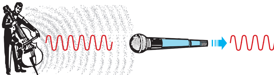
Figure 186 : Un microphone fait l'inverse de ce que fait un haut-parleur, c'est-à-dire qu'il capte les vibrations acoustiques et les convertit en une tension alternative de fréquence égale à celle des notes acoustiques captées. Etant donné que la valeur de la tension alternative fournie sur la sortie d'un microphone est toujours très faible, il faut nécessairement la préamplifier. La sortie du microphone est toujours reliée à l'entrée du préamplificateur par un câble blindé pour éviter de capter des signaux parasites ou des bruits dus au courant.
