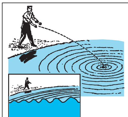
Figure 192 : Pour comprendre comment une onde sonore se forme, essayez de jeter un caillou dans un étang. Vous verrez se former des cercles (ondes) concentriques qui se propageront du centre vers l'extérieur, sans créer de courants mais seulement des ondulations. En effet, si l'on pose sur l'étang un bouchon de liège, on le verra seulement descendre et remonter, sans jamais se déplacer vraiment. Les ondes sonores font osciller les molécules d'air sans remuer l'air, au contraire des hélices d'un ventilateur qui génèrent du vent mais pas de son.
