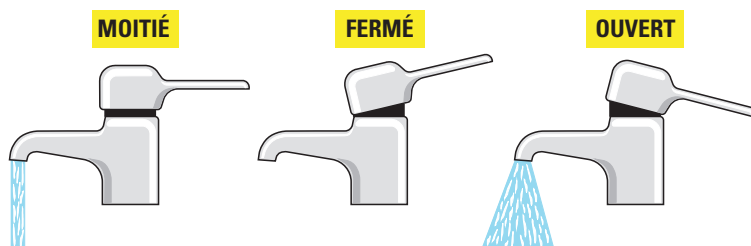
Figure 476 : Le levier d'ouverture et de fermeture d'un robinet qui simule un FET est fixé dans le sens inverse de celui d'un robinet normal.
