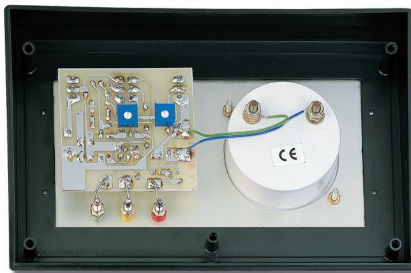
Figure 469b : Vue, dans le boîtier, du circuit du testeur de transistors et de l'arrière du galvanomètre.
