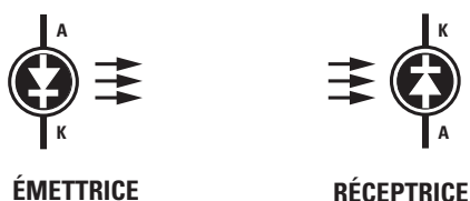
Figure 125 : Symbole graphique des photodiodes émettrices et réceptrices. Remarquez bien l'emplacement des flèches.
