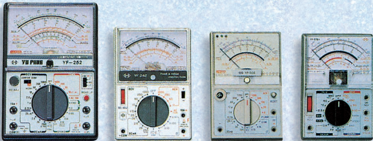
Figure 365 : Si vous décidez de faire l'acquisition d'un multimètre analogique, choisissez-en un dont la sensibilité soit d'au moins 20 000 ohms par volt, pour réduire les erreurs de lecture.
