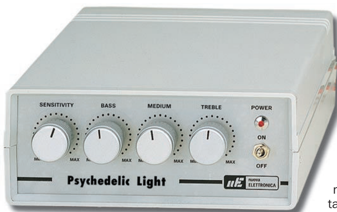
Figure 560 : Voici comment se présente, une fois terminé, le boîtier pour lumières psychédéliques capable de piloter des ampoules de 12 volts.
