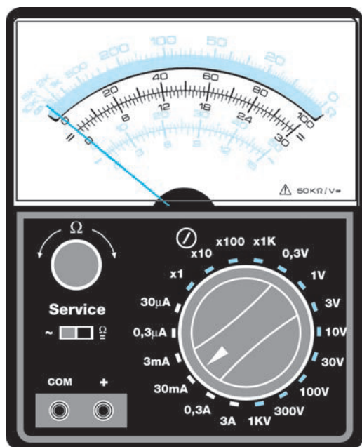
Figure 374 : Concernant la fonction ampèremètre CC, en tournant le bouton sur les échelles indiquées 30-0,3 \mu A, 3-30 mA ou 0,3-3 A, la valeur sera lue sur l'échelle graduée de 0 à 30. Pour l'échelle 0,3 A, la valeur sera divisée par 100, tandis que pour l'échelle 3 A, elle sera divisée par 10.
