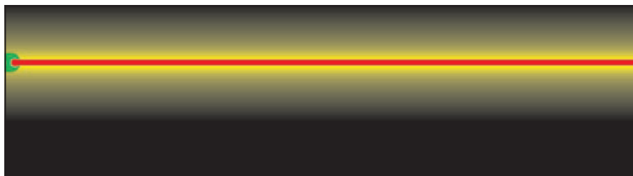
Figure 347 : Le rayon infrarouge émis par la diode émettrice est invisible. La distance de transmission maximale de ce rayon est d'environ 3 mètres. Une fois cette distance dépassée, le récepteur ne pourra plus fonctionner.
