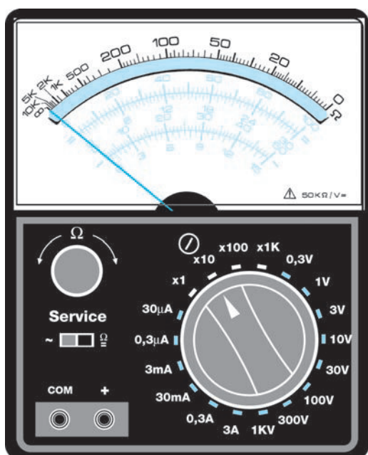
Figure 372 : Concernant la fonction ohmmètre, la valeur de la résistance lue sur l'échelle "Ω" sera multipliée par le facteur indiqué par le bouton des échelles, c'est-à-dire x1, x10, x100, x1K. Chaque fois que vous changerez d'échelle, vous devrez court-circuiter les deux pointes de touche et régler à nouveau le potentiomètre de calibrage.
