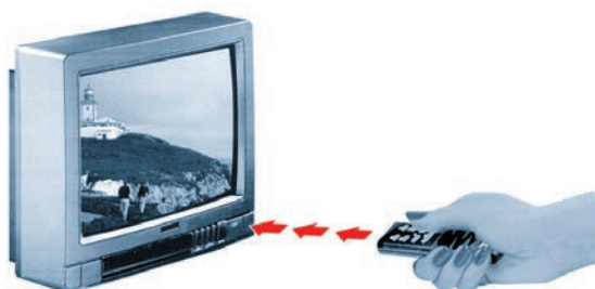
Figure 127 : Dans les télécommandes, on utilise des photodiodes à infrarouges.
