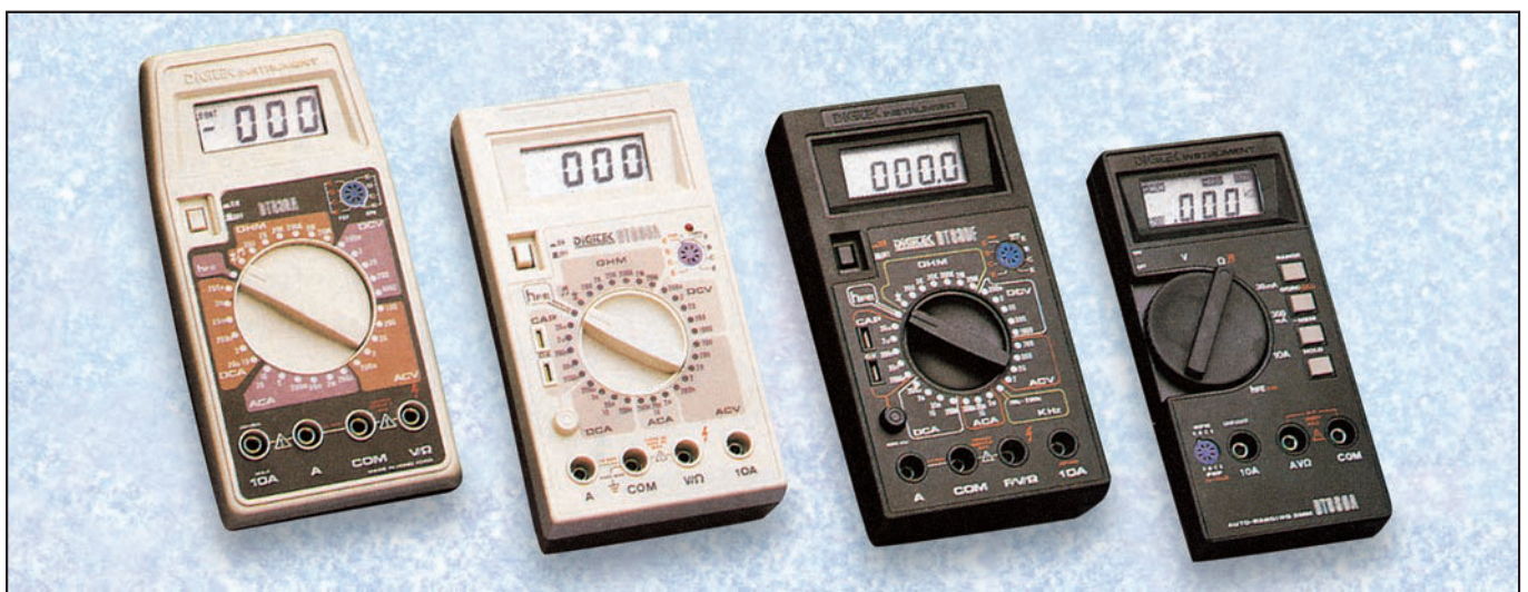
Figure 379 : Un bon multimètre digital doit avoir au moins 4 chiffres, qui correspondent en fait à 3 chiffres et demi, car le premier, celui de gauche, ne permet jamais de visualiser un nombre supérieur à 1. Choisissez si possible un modèle faisant apparaître sur l'afficheur à cristaux liquides, les symboles W, kW, MW, \mu V, V, \mu A, mA, même s'il doit vous coûter plus cher. Vous saurez ainsi toujours et sans risque d'erreur sur quelle gamme vous vous trouvez.
