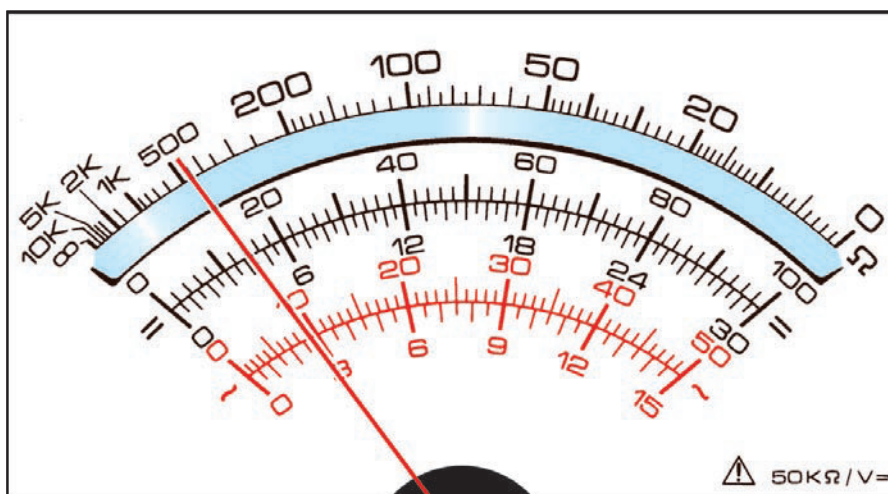
Figure 368 : Sur le cadran d'un multimètre analogique, on trouve une seule échelle graduée pour les résistances (en ohms), qui part de gauche avec 10 kilohms et finit à droite avec 0 ohm, deux échelles graduées de 0 à 100 et de 0 à 30 pour lire les tensions (en volts) et les courants (en ampères) en "continu", et deux échelles graduées de 0 à 50 et de 0 à 15 pour lire les tensions (en volts) et les courants (en ampères) en "alternatif".
