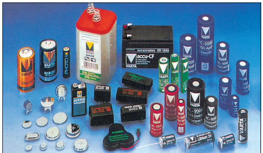
Fig. 37 : Dans le commerce, on peut trouver des piles de tensions et de dimensions diverses. La capacité d'une pile est exprimée en ampère/heure. Une pile de 3 Ah se décharge en une heure si l'on prélève 3 ampères, en deux heures si l'on prélève 1,5 ampère et en 30 heures si l'on prélève 0,1 ampère.
